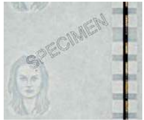
Dokumentni papir s pozicioniranim multitonskim vodenim znakom, na papir ugrađenom sigurnosnom magnetnom niti 3,5 mm u dvije boje i mikrotekstom, koje se na svjetlosti prelijevaju
