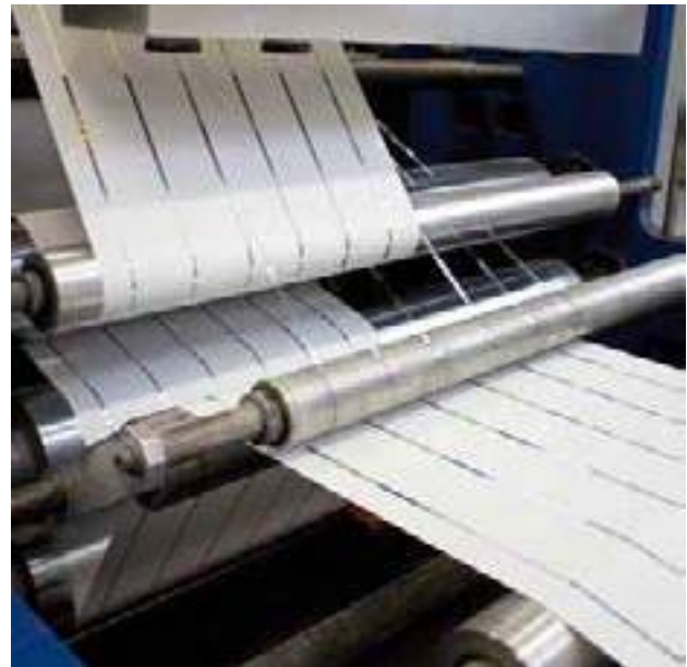
Prikaz strojnog nanošenja holograma na papir, rola-rola
