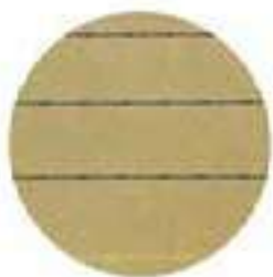
Prikaz zaštitne niti s nano tekstom, metalizirana i nevidljiva nit 0,8 mm, fluorescentna crvena pod UV svjetlom ugrađena u papir
