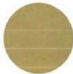
Prikaz zaštitne demetalizirane niti s nano tekstom i nevidljive niti 0,8 mm ugrađene u papir
