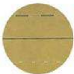
Prikaz zaštitne niti s nano tekstom, metalizirana i demetalizirana ugrađena u papir
